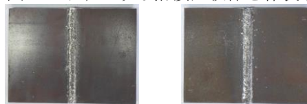
図1 溶接試験体 (左: SM490A, 右: SM570)
